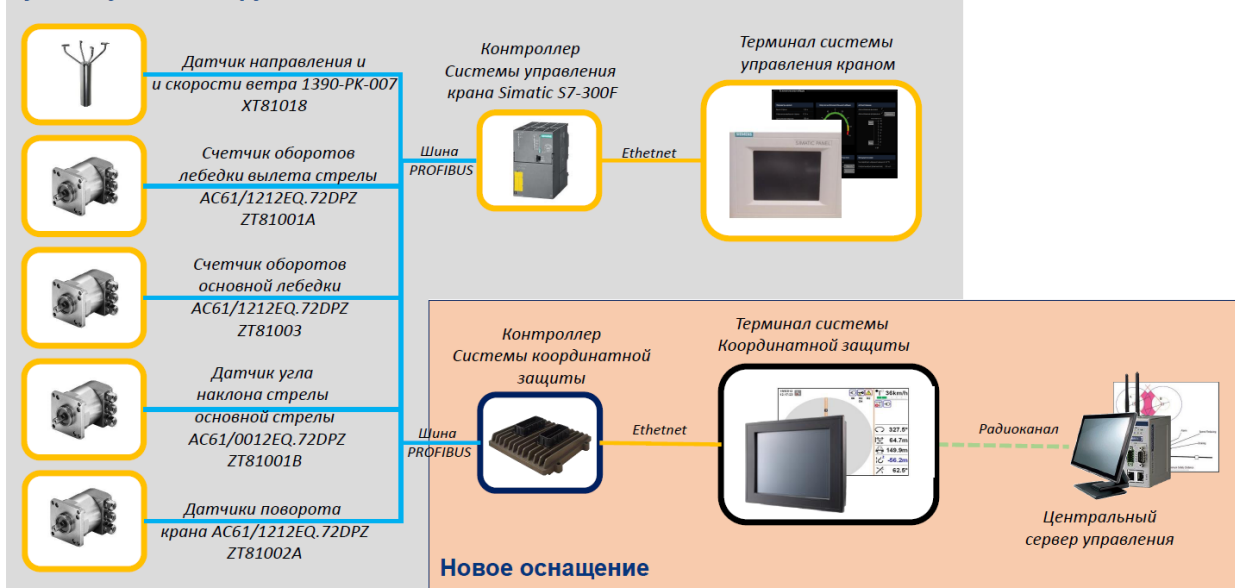
Рисунок 4.50 – Архитектура системы с учётом существующего оснащения
